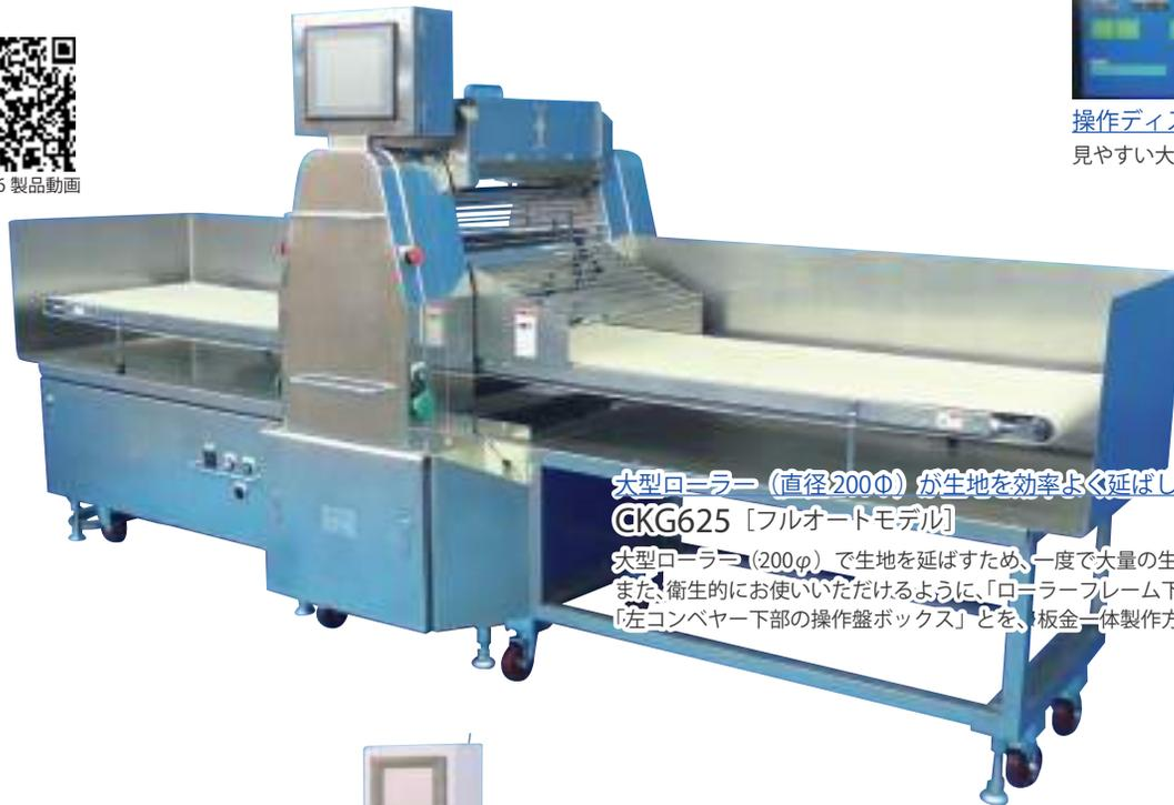
大型ローラー (直径200Φ) が生地を効率よく延ばします！
